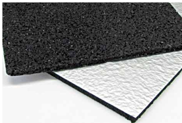
Regupol® resist solar met triplex aluminiumfolie aan de onderzijde om de migratie van weekmakers te verhinderen.
