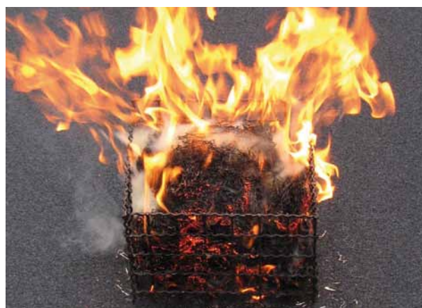
De diameter van de brandvlek is amper groter dan de vuurkorf. Het vuur drong niet door de gebouwbeschermingsbaan.
